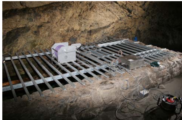
Abbildung 8: Schachtbefahrung mit der Multiparametersonde DL 512 LogIn GmbH im Maschinenschacht, Foto: WOLKERSDORFER
