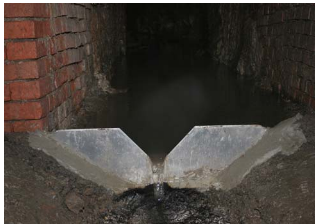
Abbildung 9 Dreieckswehr in MP 03 im Wasserstollen, Foto: Andrea Berger
