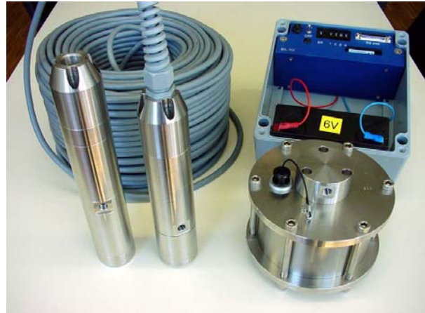
Abbildung 12: Durchfluss-Bohrloch-Fluorometers GGUN-FL 20 Ser. #13, aus SCHNEGG und COSTA (2002)
